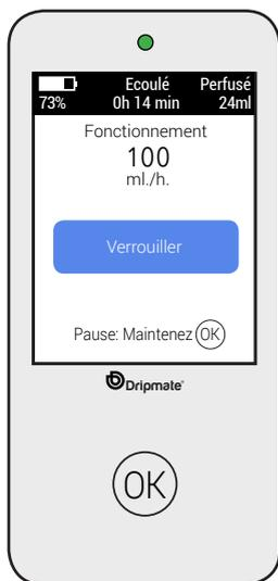
*Remarque : pendant le fonctionnement, le Dripmate maintiendra le débit de la ligne de perfusion. L'écran s'éteindra pour économiser de l'énergie, et l'indicateur de statut s'allumera en vert et clignotera. Si le Dripmate n'est pas en mesure de maintenir le débit sélectionné, une mise en garde ou une alarme sera émise.*
